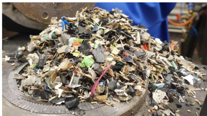
Figur 3. Bild på ackumulerad elektronikplast efter öppnandet av inmatningsutrustningen.
