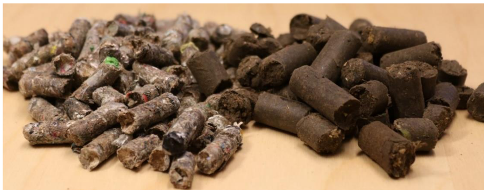
Figur 2. Bild på de två pelletsbränslena som förgasats i detta projekt, plastrejekt (i) till vänster och fordonsplast (ii) till höger.
