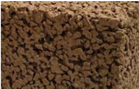
Bild 1: Härdad lättfyllnadsmassa av cellplast och cement
