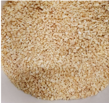
Bild 2: Nedmalt spill från tillverkning av Divinycell.
