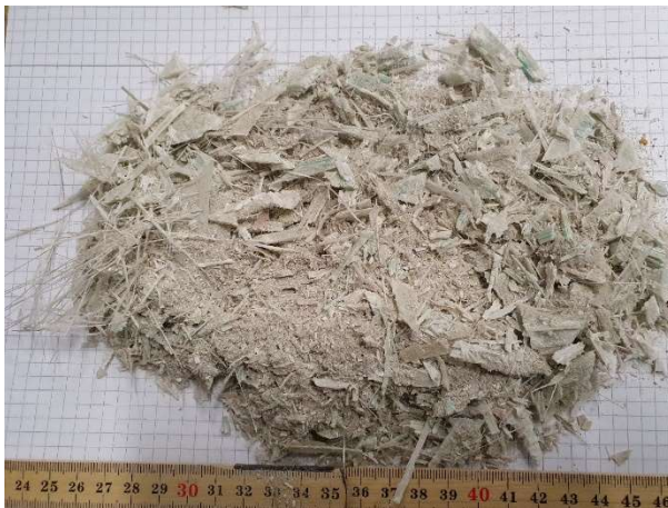
Bild 3: Nedmalda vingar med glasfiber och epoxi
